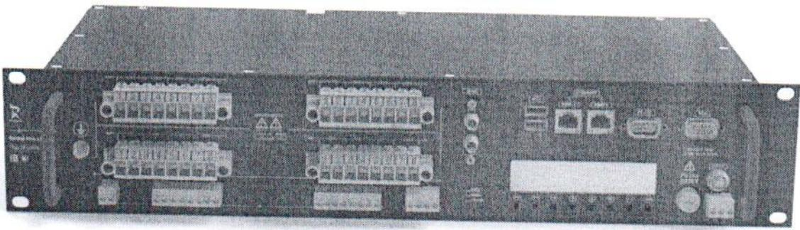
Рисунок 2 – Лицевая панель регистратора в исполнении с двумя оптическими разъемами ST для синхронизации от внешнего сервера точного времени с поддержкой IRIG-B или системы приема и передачи сигналов точного времени «ПАРМА РВ9.01»
